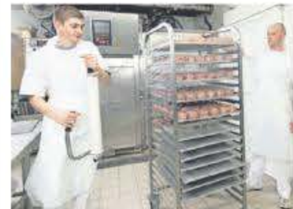
... avant d'être mis 48 heures dans un chariot transformé en étuve.
